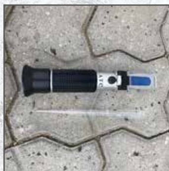
Refractometer og pipette til kontrol af blandingsforhold
